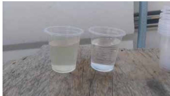
ANTES Y DESPUES DE POTABILIZAR
